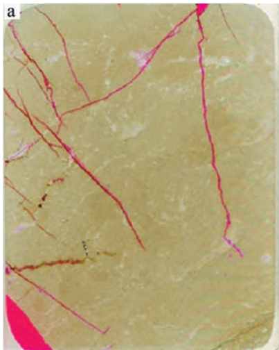
Рис. 2.6. Снимки сканированием шлифа (а) и следов открытых трещин (б) образца 16. Красное – пустотное пространство, заполненное окрашенным полимером Доломит известковый сгустковый, плотный, с тонкими секущими трещинками
